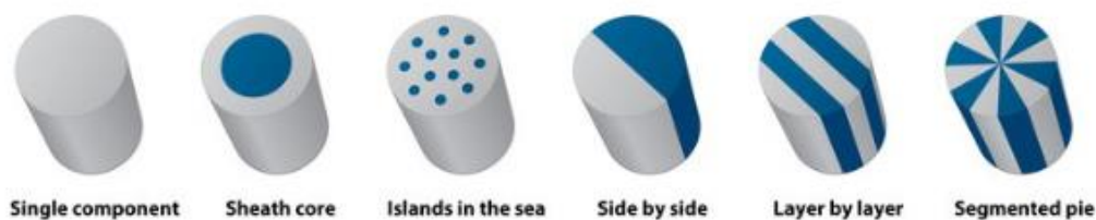
Obrázek 8 - Příklady typů bikomponentních vláken, [19]
