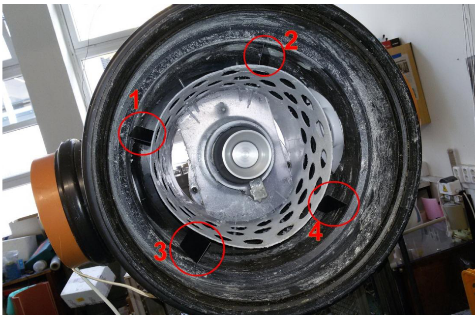
obr. 54: 4 kartonové lopatky uvnitř krytu odstředivky
