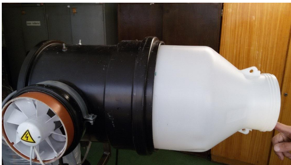
obr. 52: Barel bez podstavy nasunutý do krytu odstředivky
