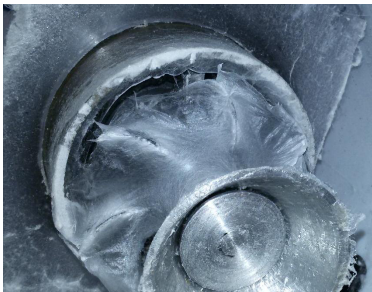
obr. 74: Zaschlé vrstvy polymerního roztoku na spinneretě a jejím okolí, které je nutno odstraňovat; ne vždy však zcela úspěšně
