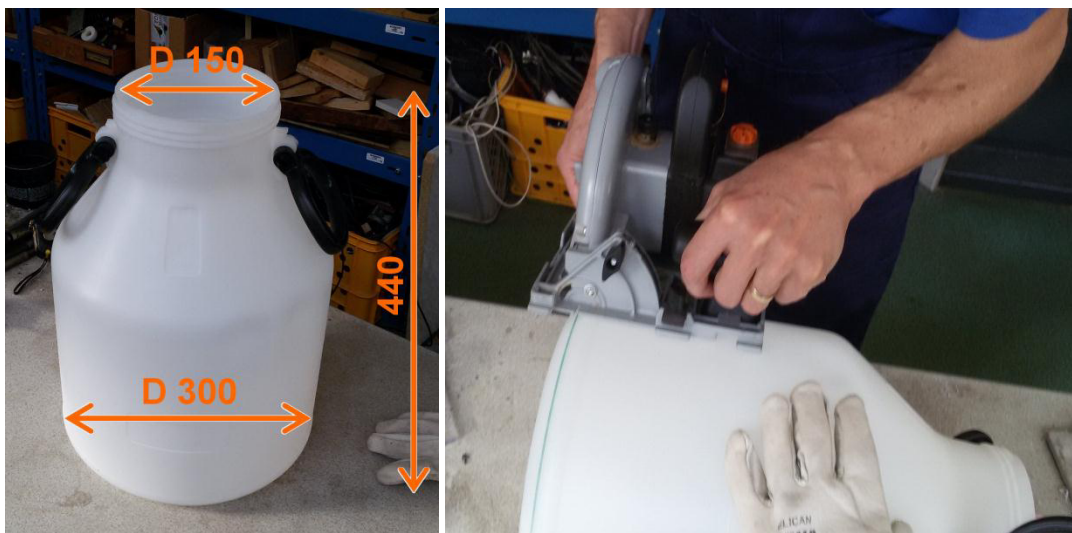
obr. 50 a 51: Vlevo: Původní barel před úpravou; vpravo: Odřezání podstavy barelu
