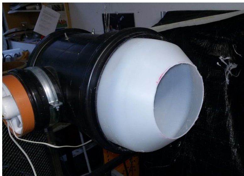
obr. 53: Úprava barelu s výstupním otvorem o průměru 190 mm
