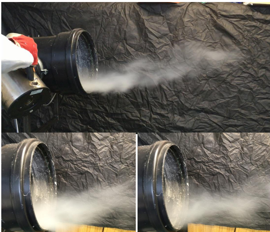
obr. 36-38: Výstup plynu z odstředivky. Lze vidět tendenci oxidu uhličitého klesat dolů
