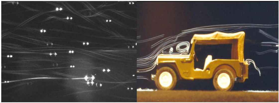
obr. 22: Ukázky vizualizace pomocí héliových bublinek o velikosti 0,75 – 5 mm [18]
