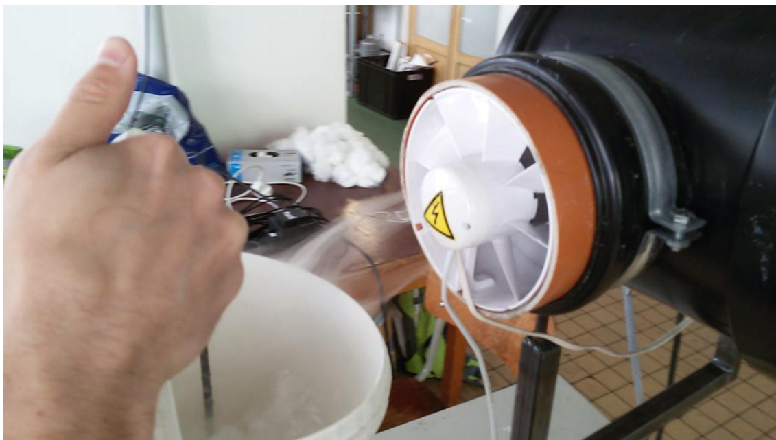
obr. 32: Pokus s vodní párou: vhnání do ventilátoru odstředivky
