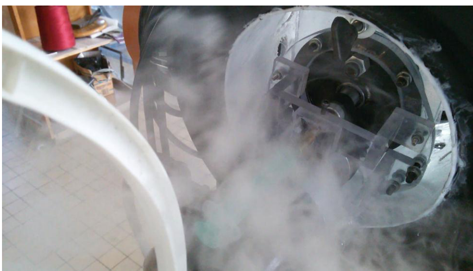
obr. 31: Pokus s vodní párou: vhánění do zadní části odstředivky
