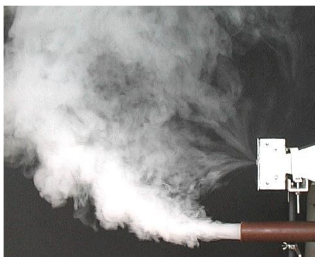
obr. 26: Vizualizace odsávání vzduchu z prostoru pomocí kouře [18]
