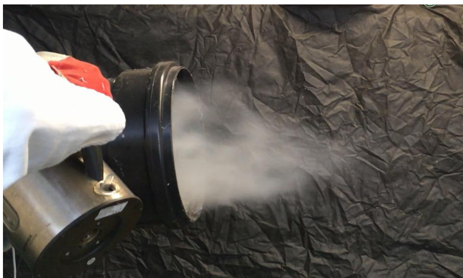
obr. 33-35: Ukázka pokusů se suchým ledem. Nahoře nasávání plynu do odstředivky přes ventilátor, dole jeho výstup
