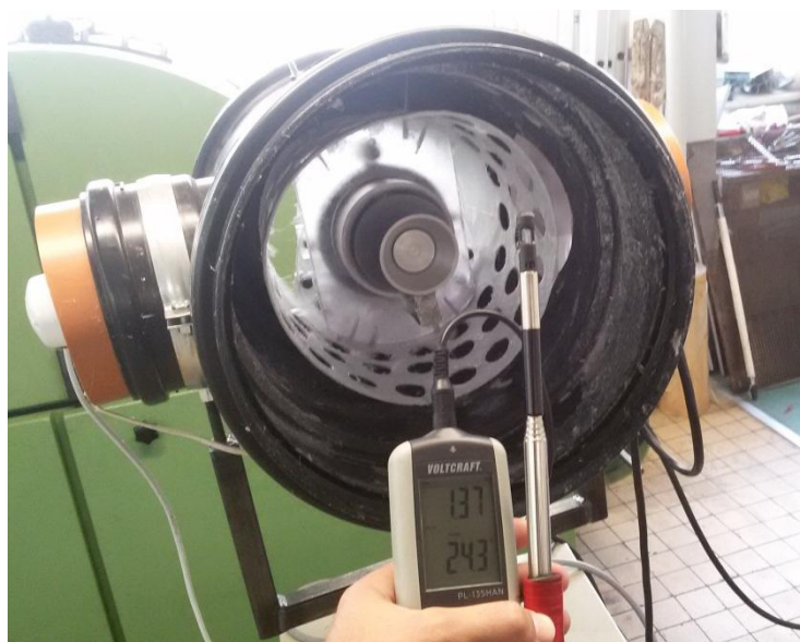
obr. 39: Ukázkou měření rychlostí vzduchu anemometrem
