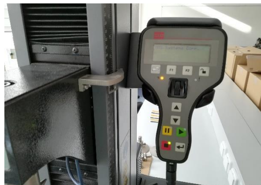
Obr. 53 Řídící část trhačky
