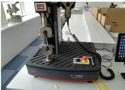
Obr. 52 Spodní část trhačky s čelistmi
