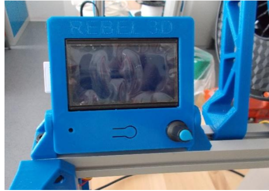
Obr. 15 Obrazovka tiskárny, (bílé) vlevo je SD karta, k ovládní slouží tlačítko vpravo dole
