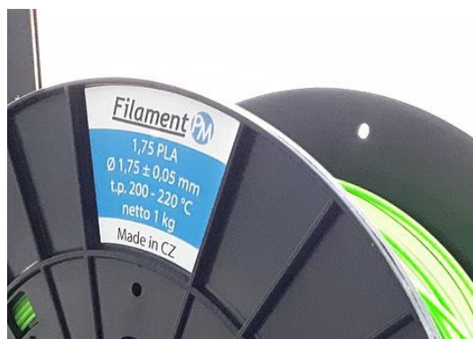
Obr. 13 Detail štítku s údaji o materiálu
