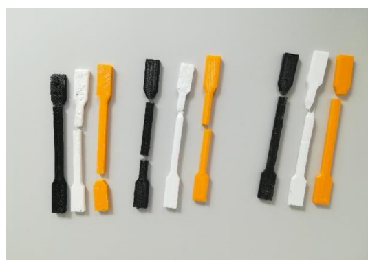
Obr. 59 Vzorky po testech na tah
