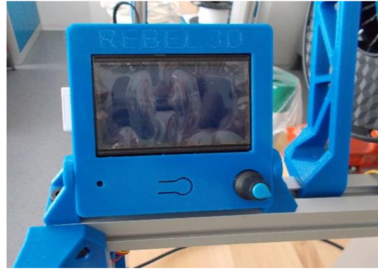
Obr. 15 Obrazovka tiskárny, (bílé) vlevo je SD karta, k ovládání slouží tlačítko vpravo dole
