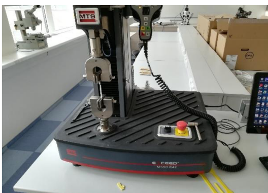
Obr. 52 Spodní část trhačky s čelistmi
