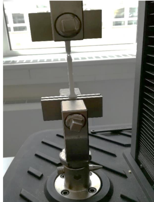
Obr. 55 Čelisti trhačky se vzorkem
