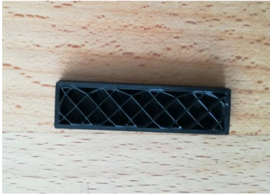
Obr. 43 Výplň vzorku – linka 10 %
