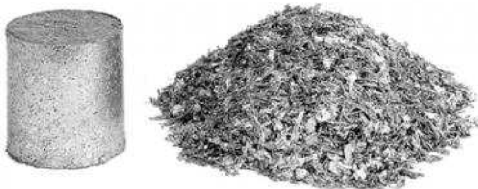
Obr. 2 - Zpracovatelský odpad v podobě třísek po obrábění kovů je nutné briketovat [4]
