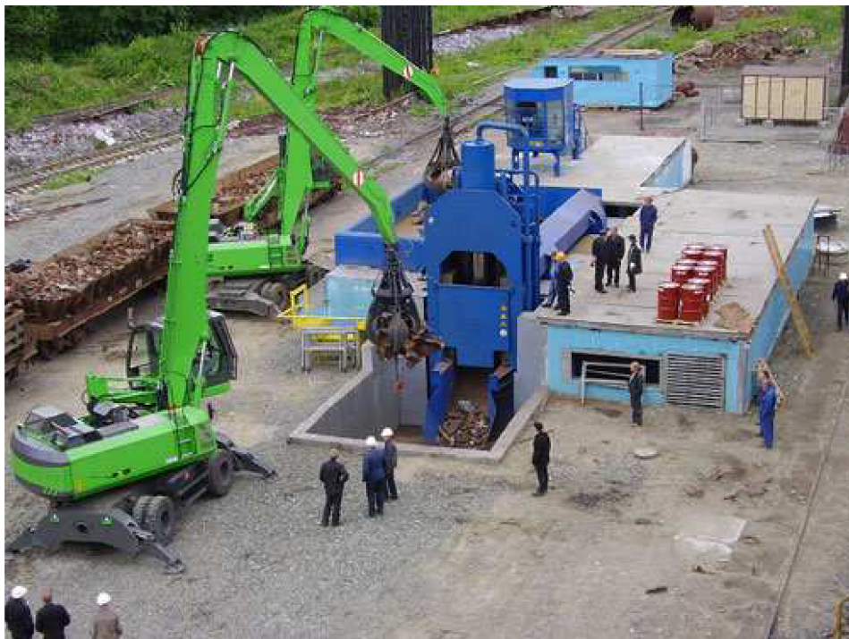
Obr. 8 - Nůžky CIB s hydraulickým pohonem (DANIELI HENSCHEL)
