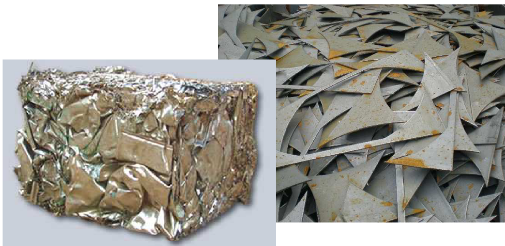
Obr. 3 - Zhutnění odpadu z nástřihových linek lze provést paketováním [7], [8]
