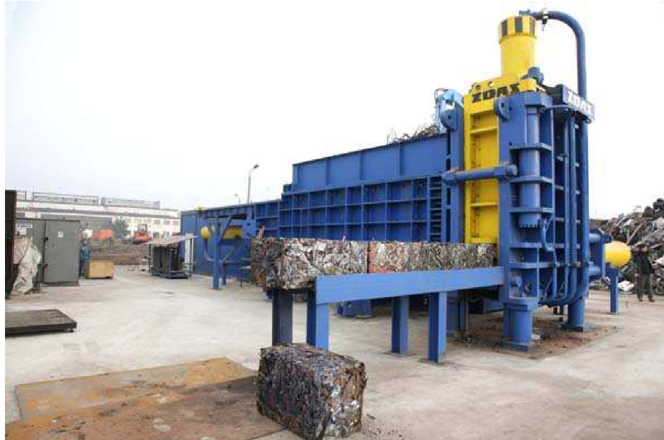
Obr. 12 - Příklad využití - Paketovací lis CPS uprostřed šrotiště (ŽDAS a.s.)
