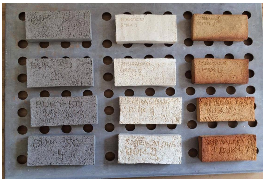
Obrázek 12 - Cihličky vysušené (šedá barva), vypálené na teplotu 900 °C (bílá barva) a vypálené na teplotu 1500 °C (oranžová barva)
