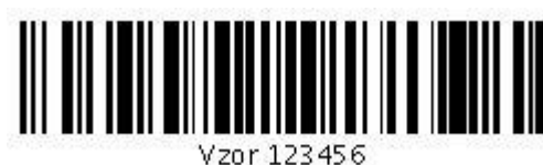
Obrázek 4: Vzor čárového kódu (Code 128)
