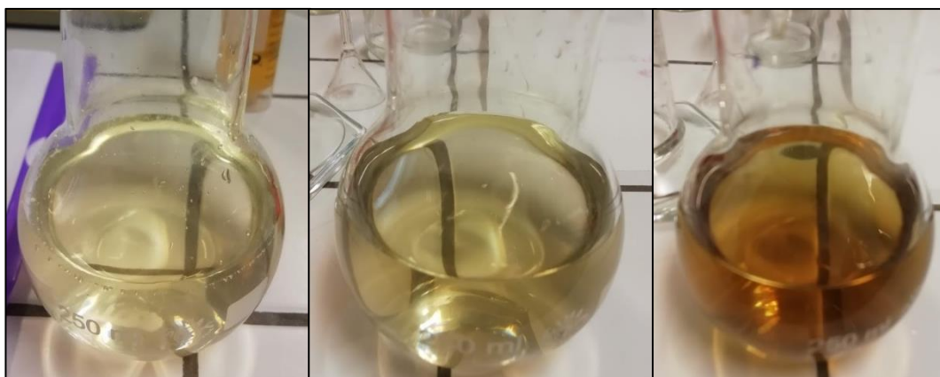
Obrázek 11: Fáze titrace s jodičnanem, vlevo barva vzorku před titrací, uprostřed první změna zbarvení, pravděpodobný bod ekvivalence, vpravo barva po přetitrování
