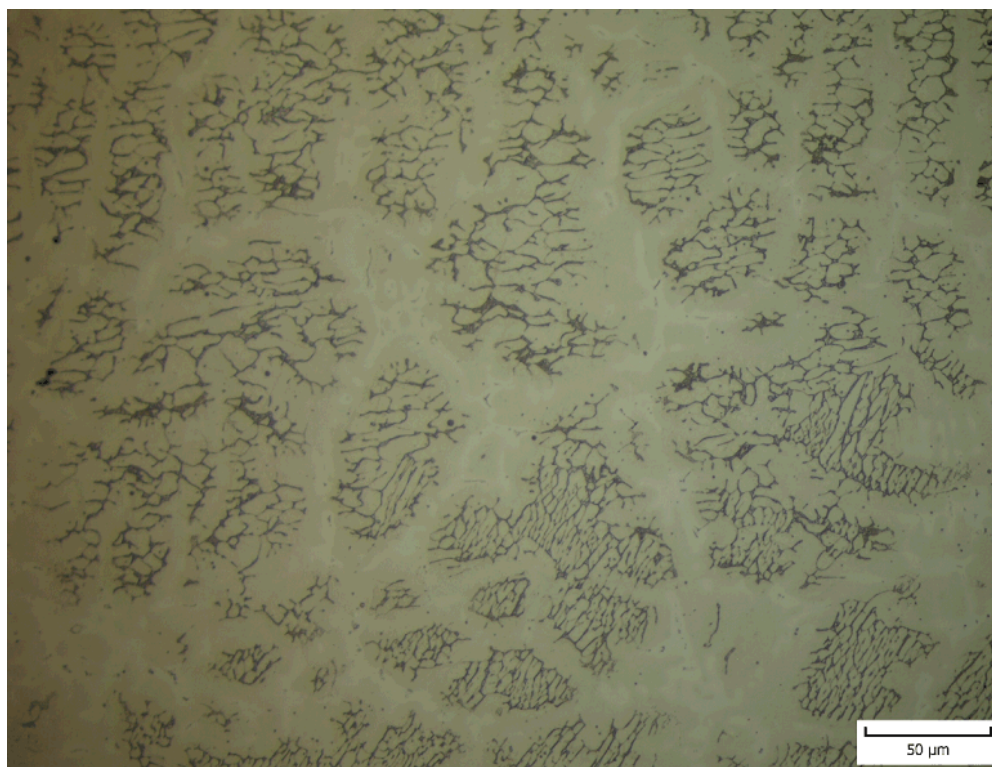
Obrázek 4.11: Středová zrna experimentálního odlitku austenitu. Zrna se velmi liší svou velikostí. V rámci středové oblasti nevykazují jasnou tendenci zvětšovat se směrem do středu odlitku.
