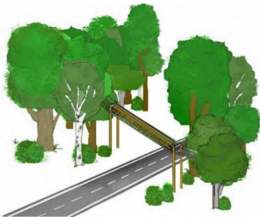
Obrázek č.24 Speciální nadchod pro drobné savce žijící v korunách stromů Zdroj: Hlaváč et al. 2020
