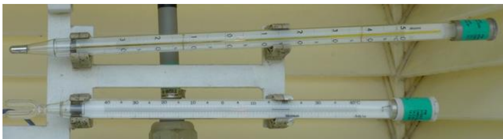
Obrázek č. 7: Teploměr maximální a minimální lihový (Zdroj: Kocourek 1994)
