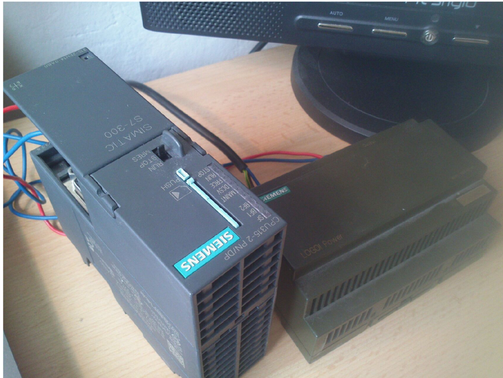
Obr. 4.1: Fotografie testovaného PLC
