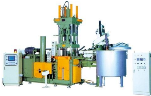
Obr. 2-11 Stroj pro výrobu odlitků metodou squeeze casting (DNR Techno Services Parda Bagh New Delhi, Indie) [21]
