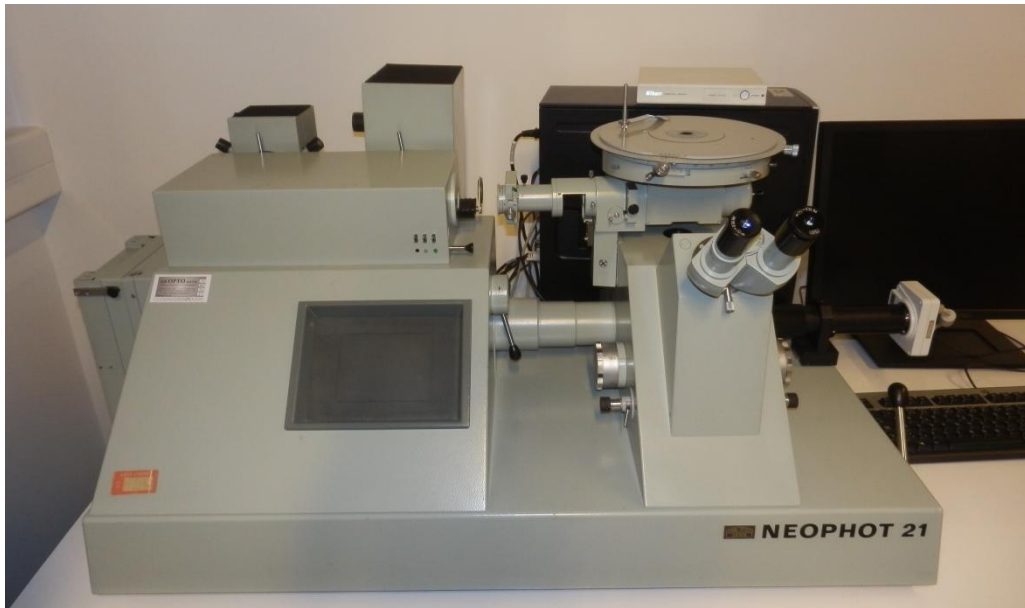
Obr. 3-10 Světelný mikroskop s kamerou a softwarem NIS Elementas AR
