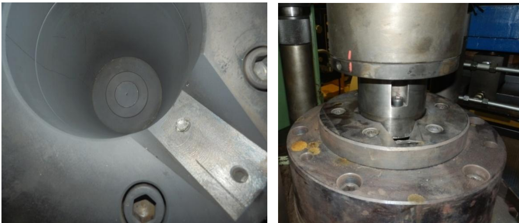
Obr. 3-2 Pohled do dutiny slévárenské formy (vlevo) a na formu s razníkem (vpravo)
