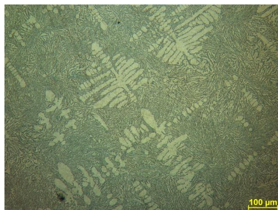
Obr. 3-14 Mikrostruktura odlitku ze slitiny AlSi12, vyrobeného metodou squeeze casting (tlak 141 MPa), leptáno kyselinou chlorovodíkovou
