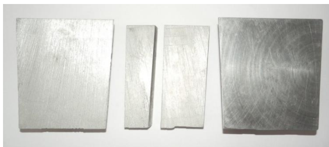
Obr. 3-8 Příprava vzorku pro metalografické pozorování z vyrobeného odlitku
