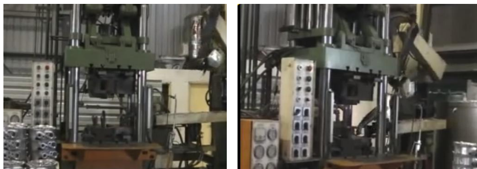
Obr. 2-13 Pohled do otevřené formy pro metodu squeeze casting [23]
