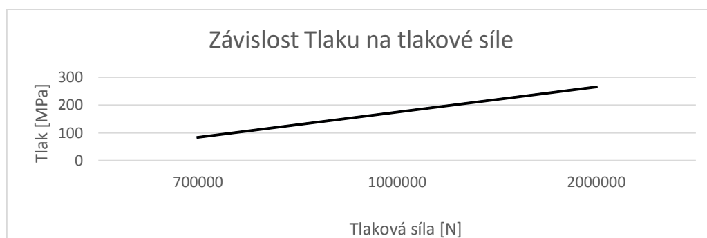
Obr. 3-7 Grafická závislost tlaku na tlakové síle (max. F = 1 500 000 [N])
