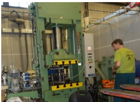
Obr. 3-1 Pohled na celkové ustavení formy k hydraulickému lisu CBA 300/63
