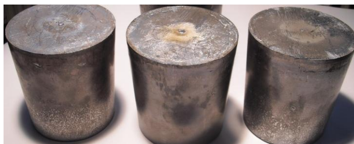
Obr 3-5 Vyrobené masivní odlitky metodou squeeze casting ze slitiny AlSi12
