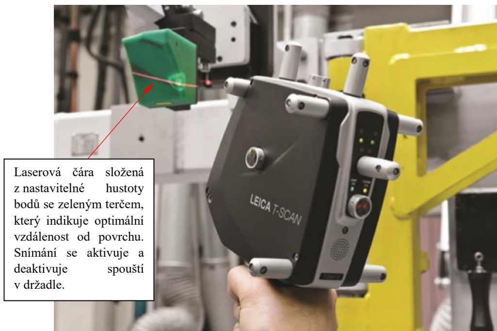
Obr. 14) Manuální 3D Laserový skener T-Scan při skenování povrchu [14]
