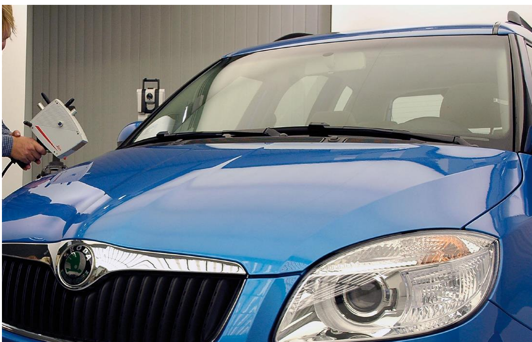
Obr. 16) Ukázka práce s manuálním 3D Laserovým skenerem [14]
