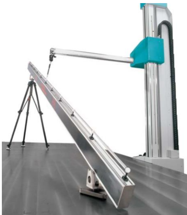
Obr. 24) Kontrolní těleso „Kugelstab 5000 mm fy. KOBA“ na 3D souřadnicovém dotykovém měřicím stroji [16]
