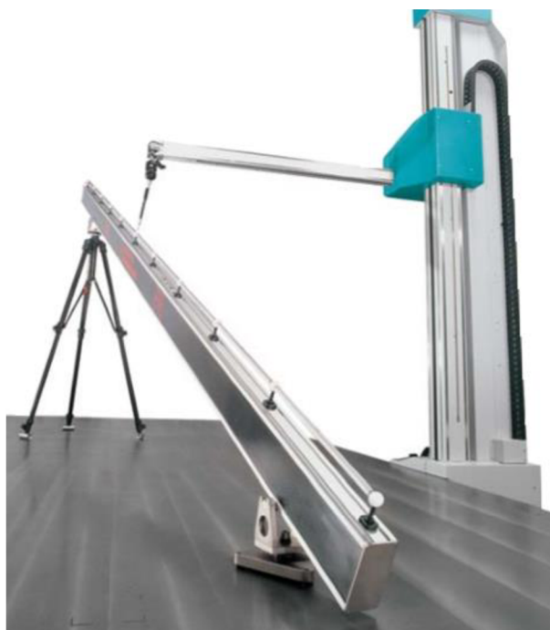
Obr. 24) Kontrolní těleso „Kugelstab 5000 mm fy. KOBA“ na 3D souřadnicovém dotykovém měřícím stroji [16]
