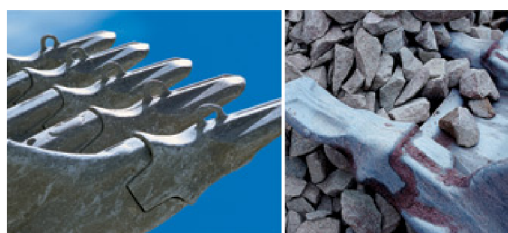
Obr. 1 : Výměnné zuby lopat
