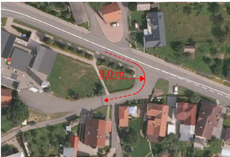
Obrázek 2.32: ZB6 – Odbočení z hlavní silnice ke staveništi [2]
