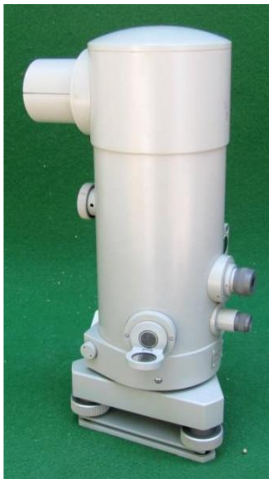
Obrázek 2.8 – Nivelační přístroj s kompenzátořem [44]
