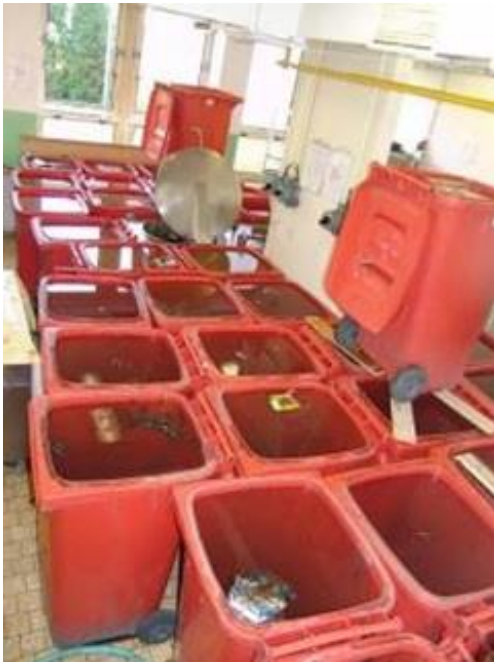
Obrázek 1.6 – Varianta zatížení – popelnice naplněné vodou [18]
