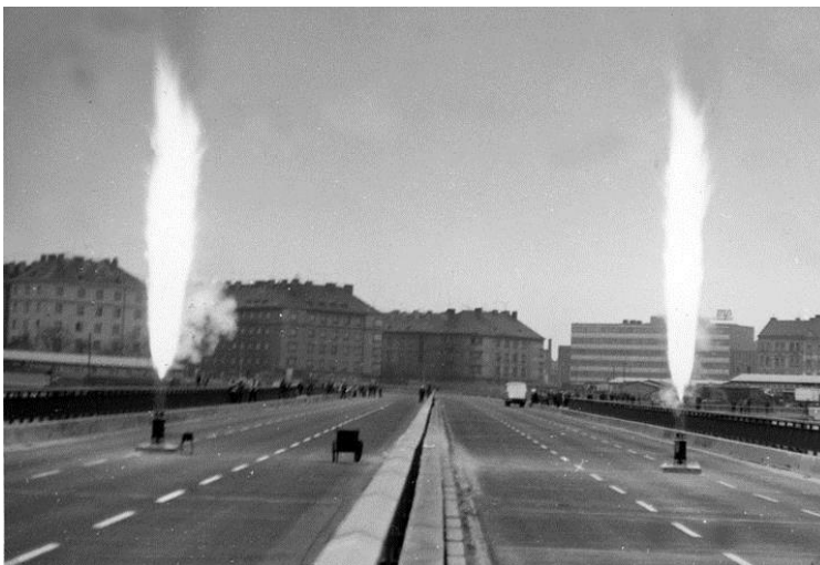
Obrázek 1.15 – Dynamické zatížení Nuselského mostu raketovými motory [36]
