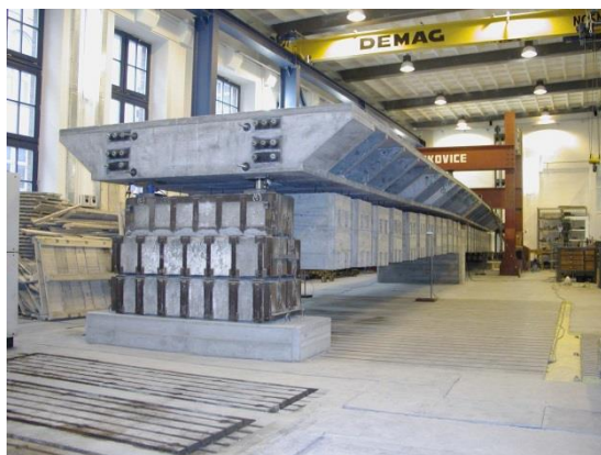
Obrázek 1.4 – Varianta zatížení – kusové závaží zavěšené – betonové kvádry [27]
