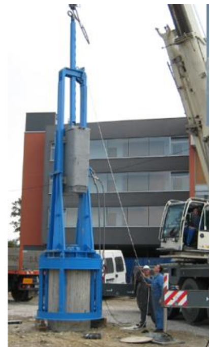
Obrázek 1.16 – Dynamické zatížení pilot rázy závažím [37]
