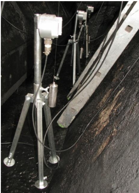
Obrázek 3.13 – Potenciometrické snímače měřící svislé posuny
