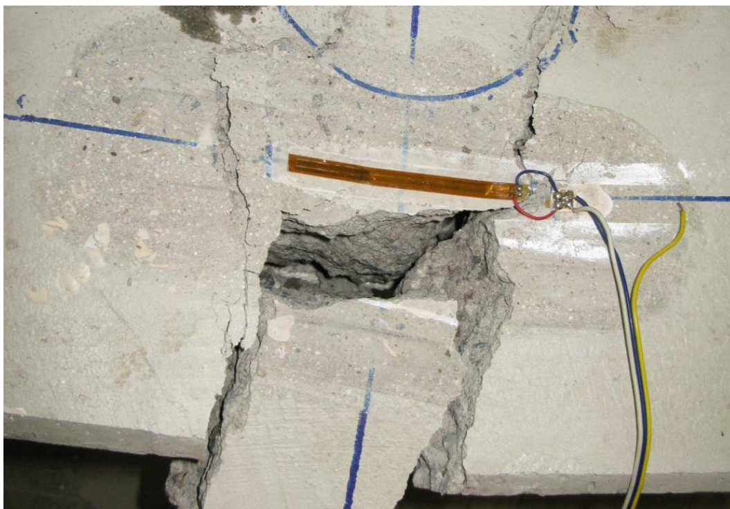
Obrázek 2.32 – Odporový tenzometr použitý při laboratorní zatěžovací zkoušce betonových panelů
