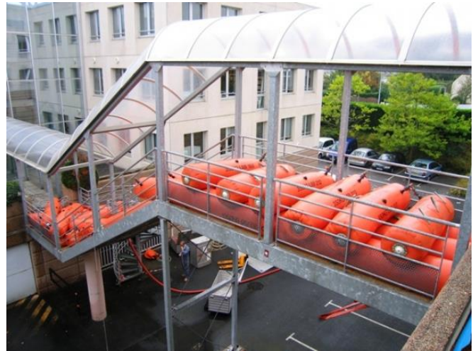
Obrázek 1.7 – Varianta zatížení – vodní vaky od firmy Proofload [31]
