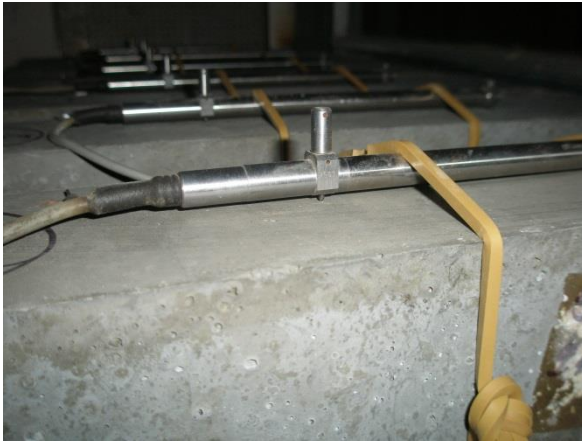
Obrázek 2.28 – Indukční extenzometry osazené na zkušebních betonových kvádrech [58]
