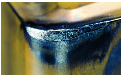
Obr. 20 - Opotřebení hřbetu břítu [20]
