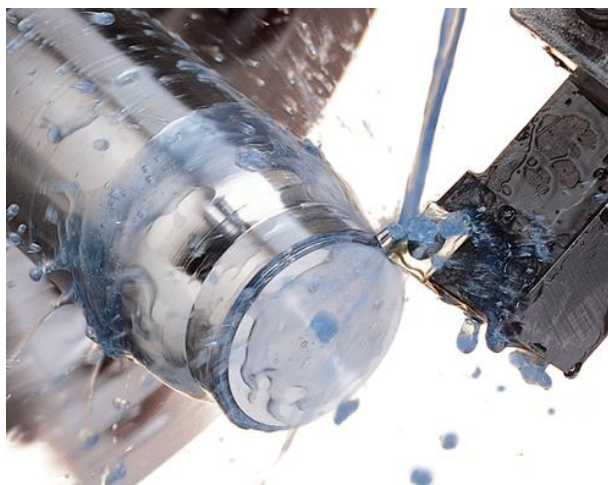
Obr. 8 – Využití syntetických kapalin při soustružení [40]
