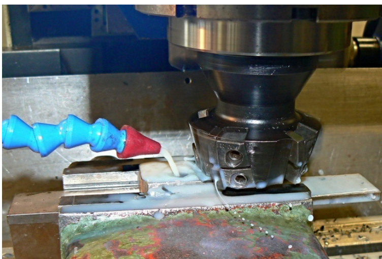
Obr. 55 – Obrábění vzorku pro měření drsnosti povrchu
