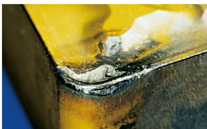
Obr. 21 - Opatřebení čela ve tvaru žlábků [20]
