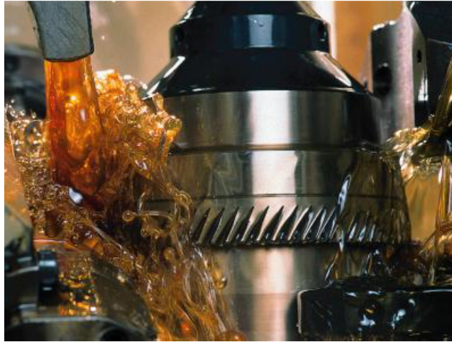
Obr. 7 – Využití minerálních olejů při obrábění ozubení [38]
