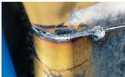
Obr. 24 - Opotřebení hřbetu ve tvaru vrubu [20]
