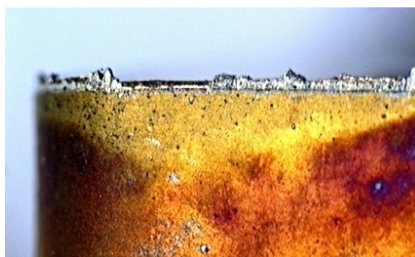
Obr. 25 - Nárůstek na břitu [14]
