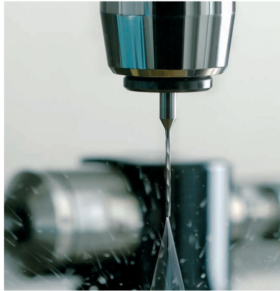
Obr. 9 – Vnitřní způsob chlazení pro vrtání [32]
