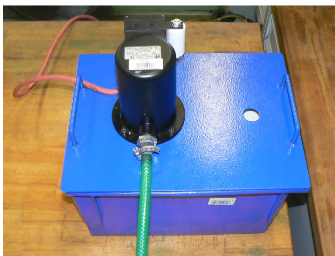
Obr. 49 – Čerpadlo s nádobou na procesní kapalinu
