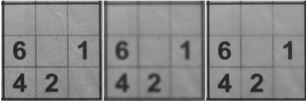
Obrázek 2.1: Vlevo je vstupní obraz, uprostřed výstup Gaussova filtru a vpravo výstup bilaterálního filtru.
