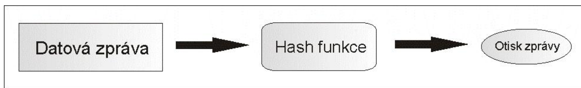
Obrázek 1: Schéma principu tvorby otisku zprávy
