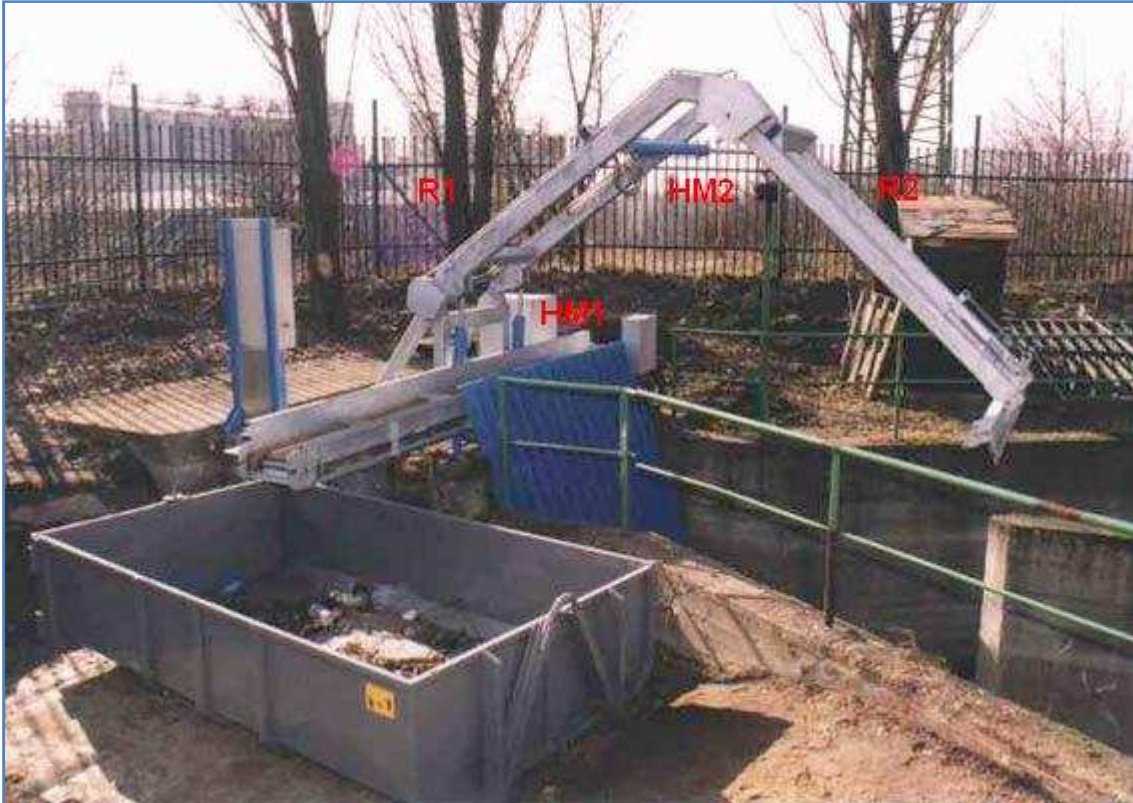
Obrázek 5: Hydraulické česla se shrabováním RnR [8]
