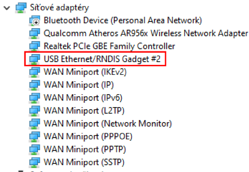
Obr. 7.3: Správně připojené Raspberry Pi Zero
