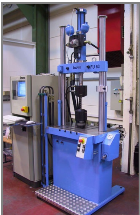
Obr. 1-7 Zkušební stroj určený pro nízkocyklové zkoušky od firmy Inova Praha s.r.o., zkušební stroj 63 kN s hydraulickými upínacími[9]
