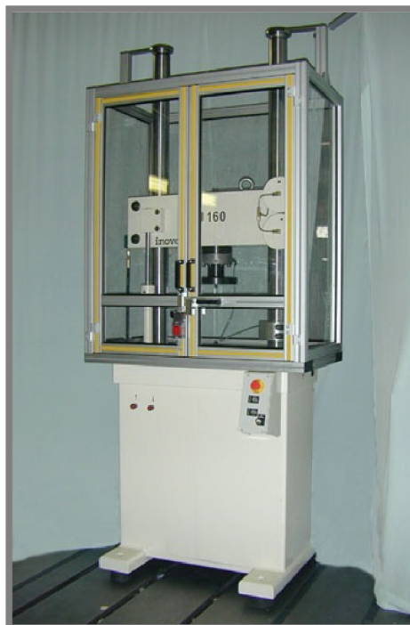
Obr. 1-8 Zkušební stroj určený pro nízkocyklové zkoušky od firmy Inova Praha s.r.o. zkušební stroj 160 kN [9]
