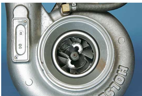
Obr. 32 Prasklé kompresorové kolo [40]
