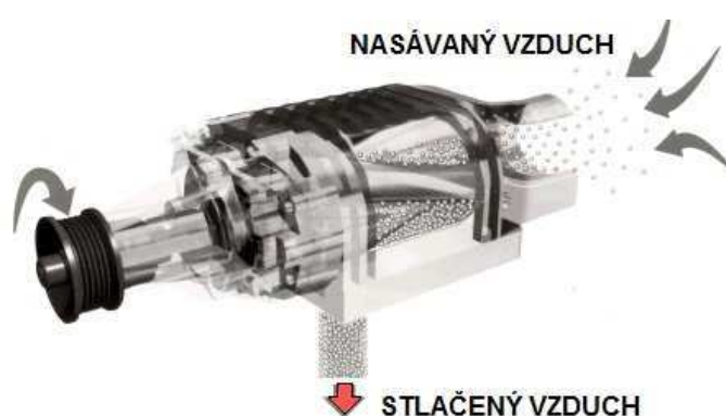
Obr. 6 Princip Rootsova dmyhadla [7]
