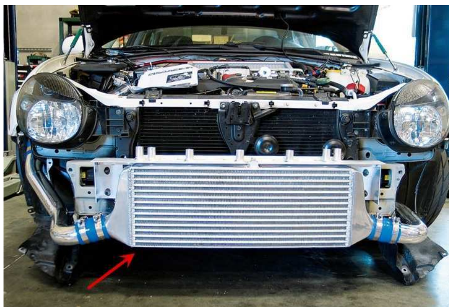
Obr. 15 Umístění chladiče plnicího vzduchu - Subaru Impreza WRX [15]
