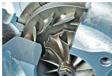
Obr. 33 Poškozené turbinové kolo [40]
