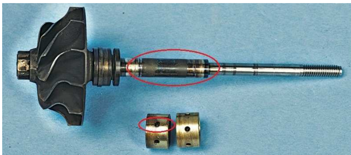
Obr. 35 Zadřený rotor a ložiska turbodmychadla [40]
