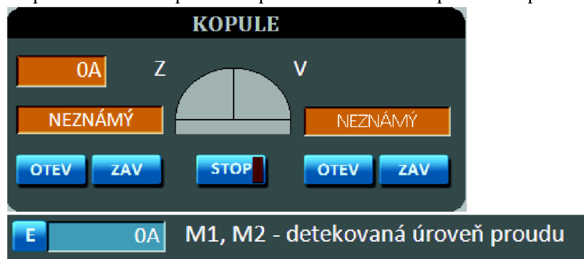
Obrázek 30 – Vizualizace – detekce přimrznutí kopule
