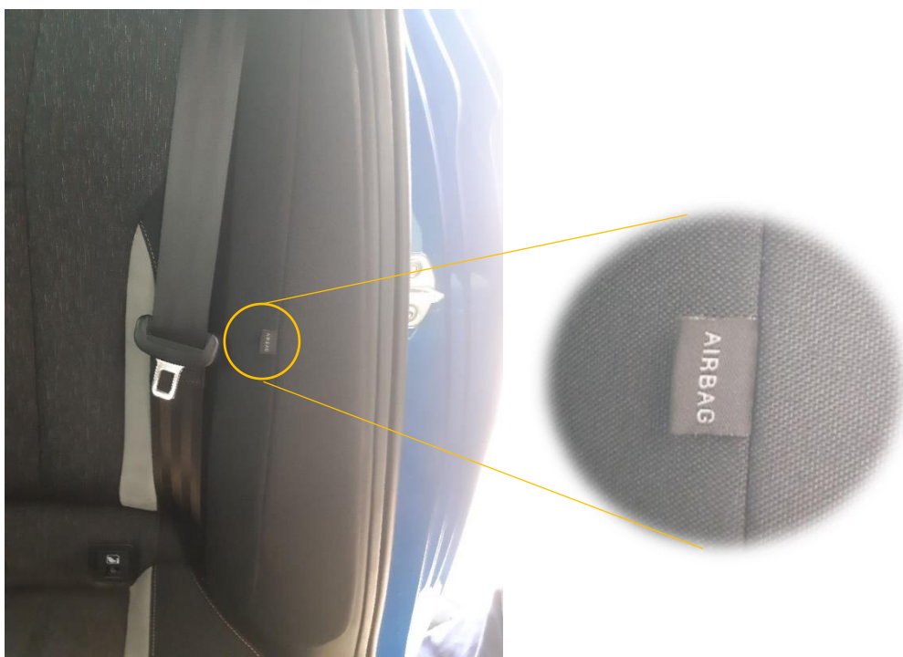
Obrázek 42 Sedadlo vybavené airbagem
