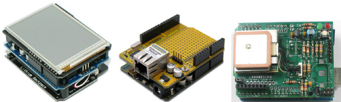
Obrázek 2.3: Moduly pro Arduino rozšiřující o dotykový displej, Ethernet rozhraní, či GPS modul. Obrázky převzaty ze stránek [12].
