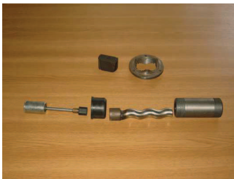
Obr. 3.7 Horní řada zleva (řezací zařízení): nůž, řezací kruh Dolní řada zleva (hydraulika): hřídelka motoru, kryt kloubu, rotor, stator (Presskan.cz)
