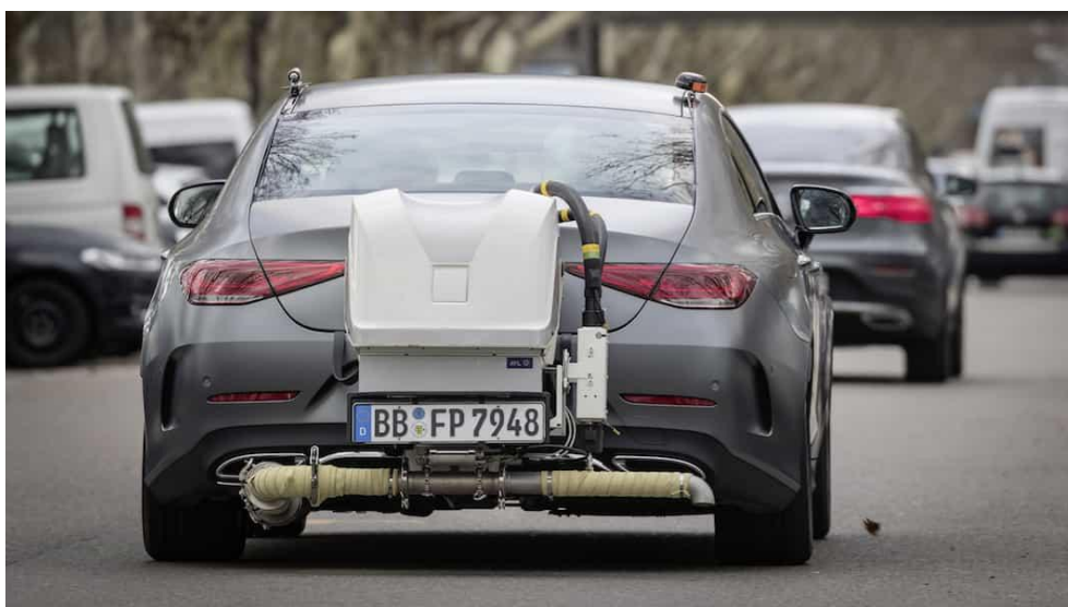
Obr. 2 Automobil s RDE testovací aparaturou v provozu
