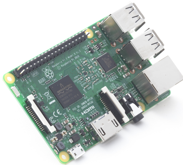
Obr. 7.1: Mini-počítač Raspberry pi 3 [14]
