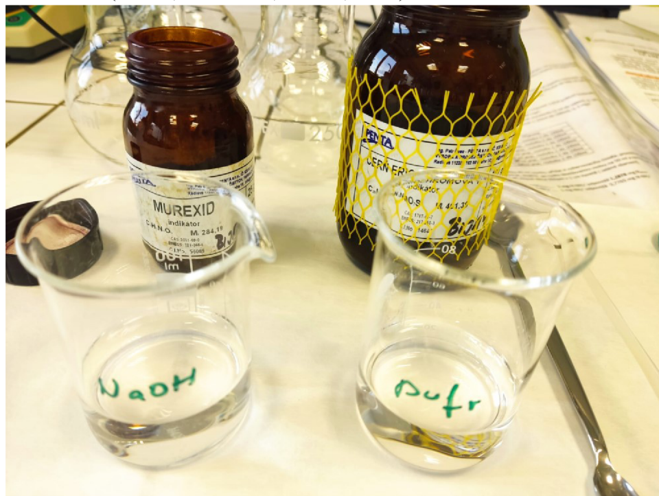
Obrázek 3 Laboratorní měření, příprava NaOH + Murexid a Puf + Eriochromčerní (zdroj vlastní, leden 2023)
