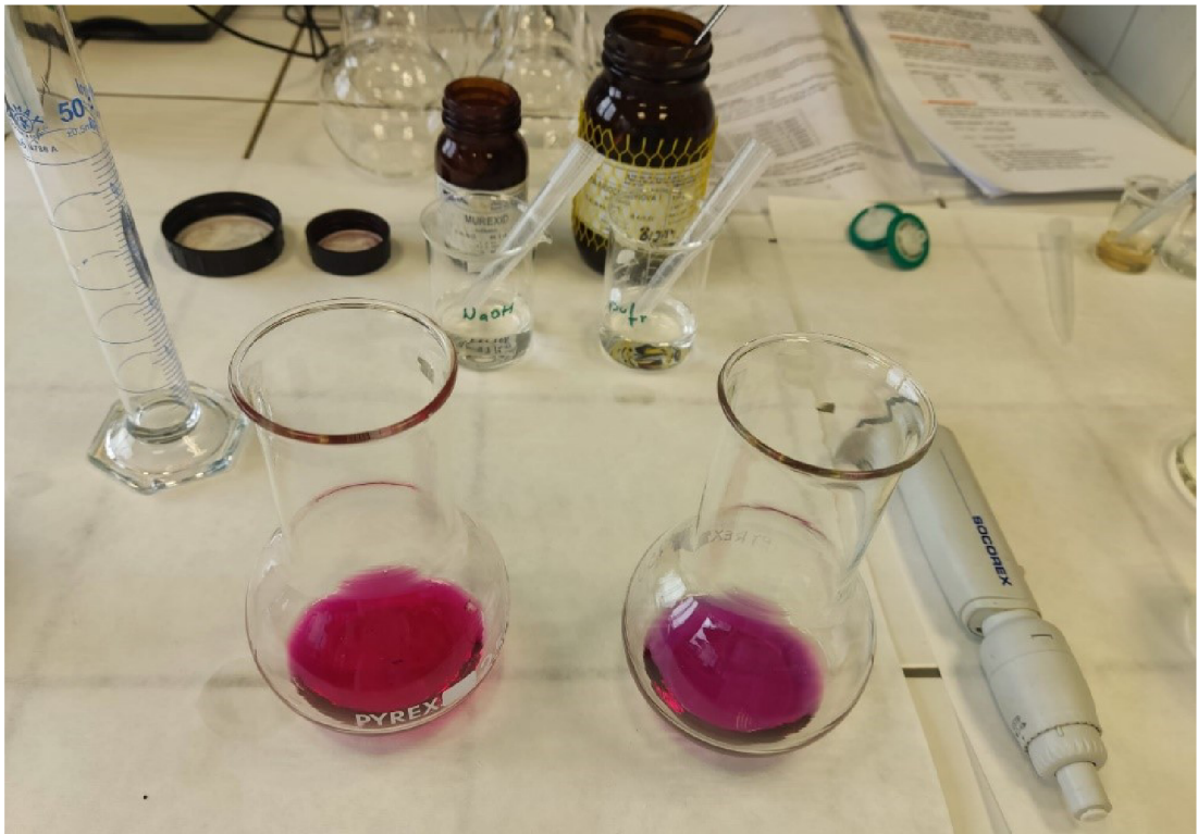
Obrázek 7 Stav před použitím Chelatonu III, vlevo měření \text{Ca}^{2+} , vpravo \text{Ca}^{2+} a \text{Mg}^{2+} (zdroj vlastní, leden 2023)
