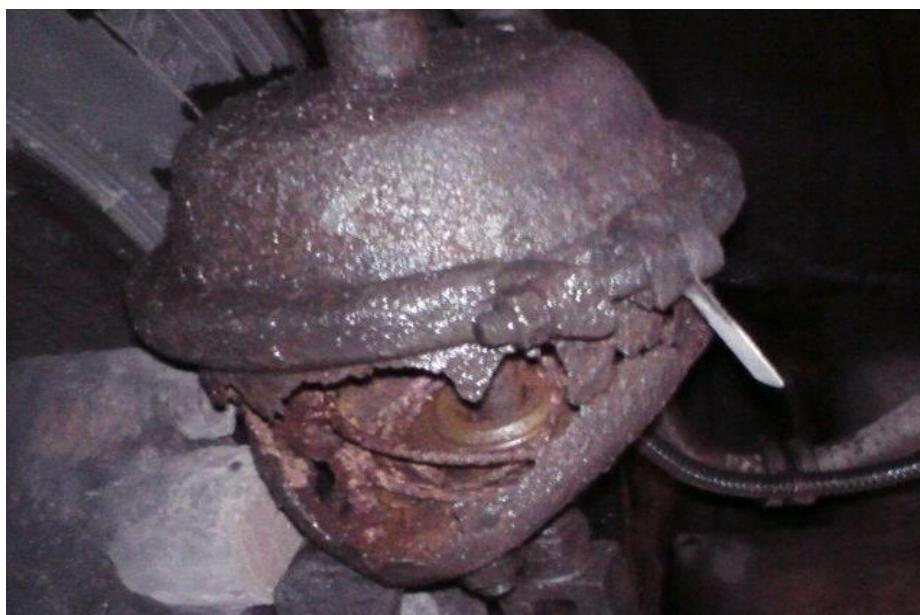
Obrázek č. 12 Koroze brzdiče, Zdroj: http://www.stkportal.cz/maestro/index.php?sekce=galerie [25.3.2016]
