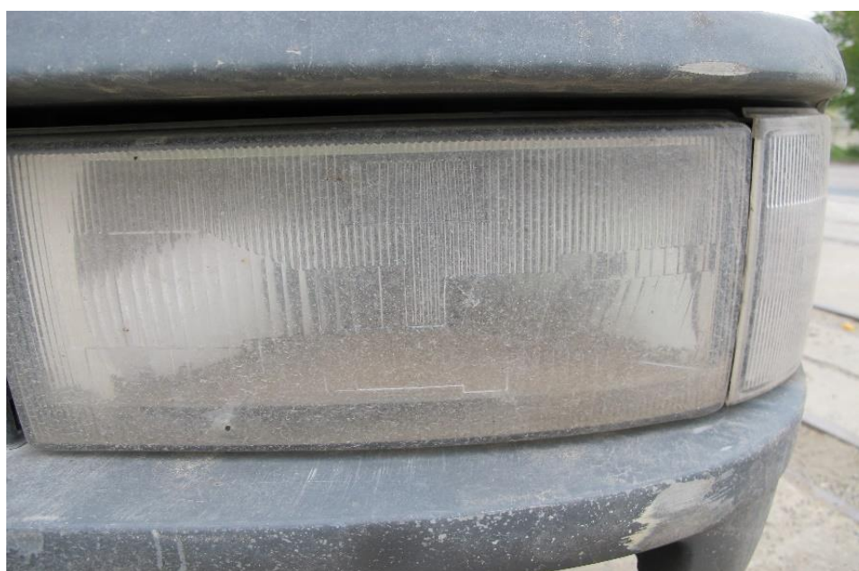
Obrázek č. 25 Poškození krytu osvětlení IVECO (vlastní foto)
