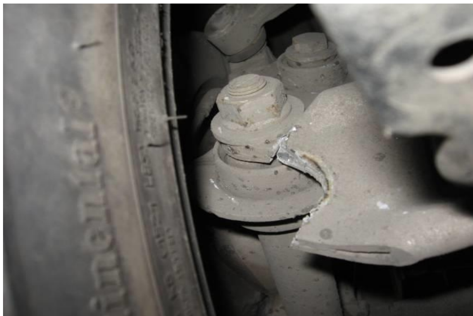
Obrázek č. 32 Prasklé spodní rameno BMW 523, Zdroj: http://www.stkportal.cz/maestro/index.php?sekce=galerie [25.3.2016]
