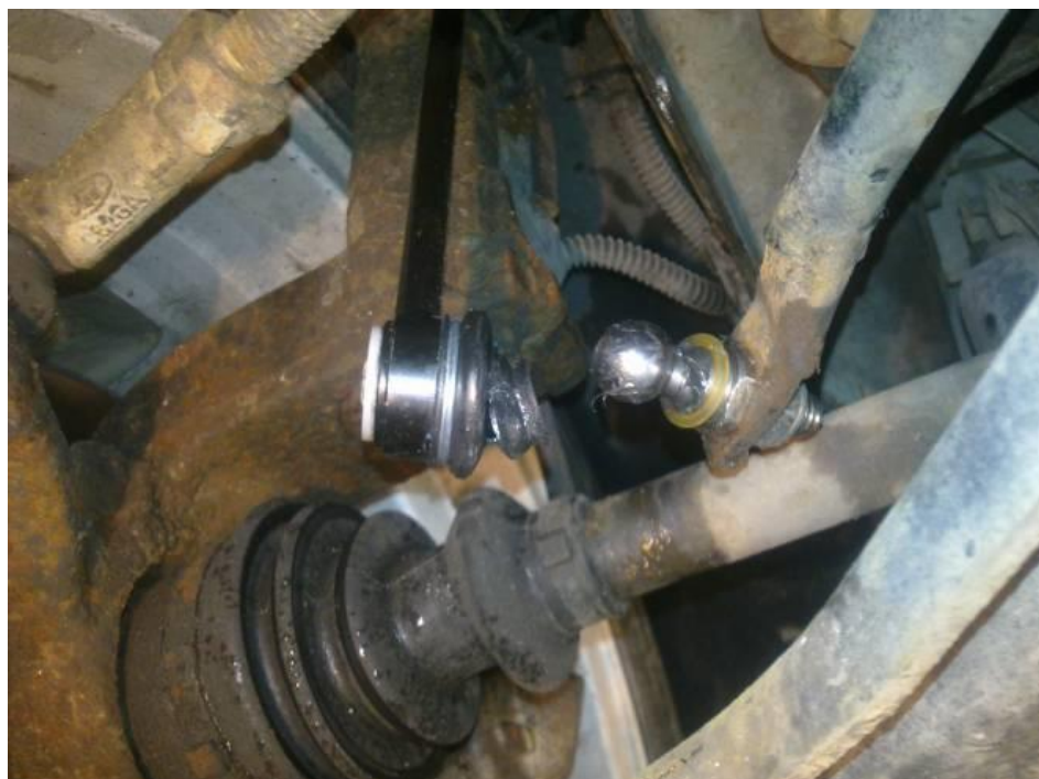
Obrázek č. 31 Poškozený čep na stabilizátoru Opel, Zdroj: http://www.stkportal.cz/maestro/index.php?sekce=galerie [25.3.2016]
