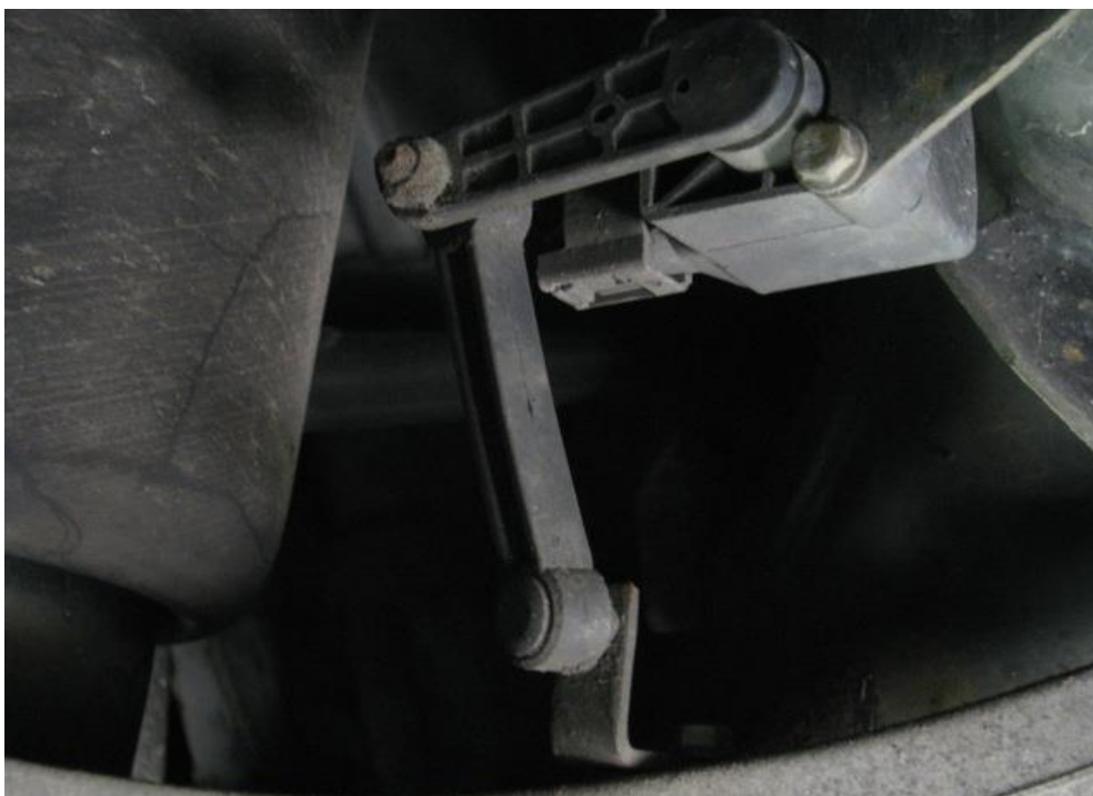
Obrázek č. 22 Část systému automatického naklápění světlometů - Mercedes Benz R320 CDI L (vlastní foto)
