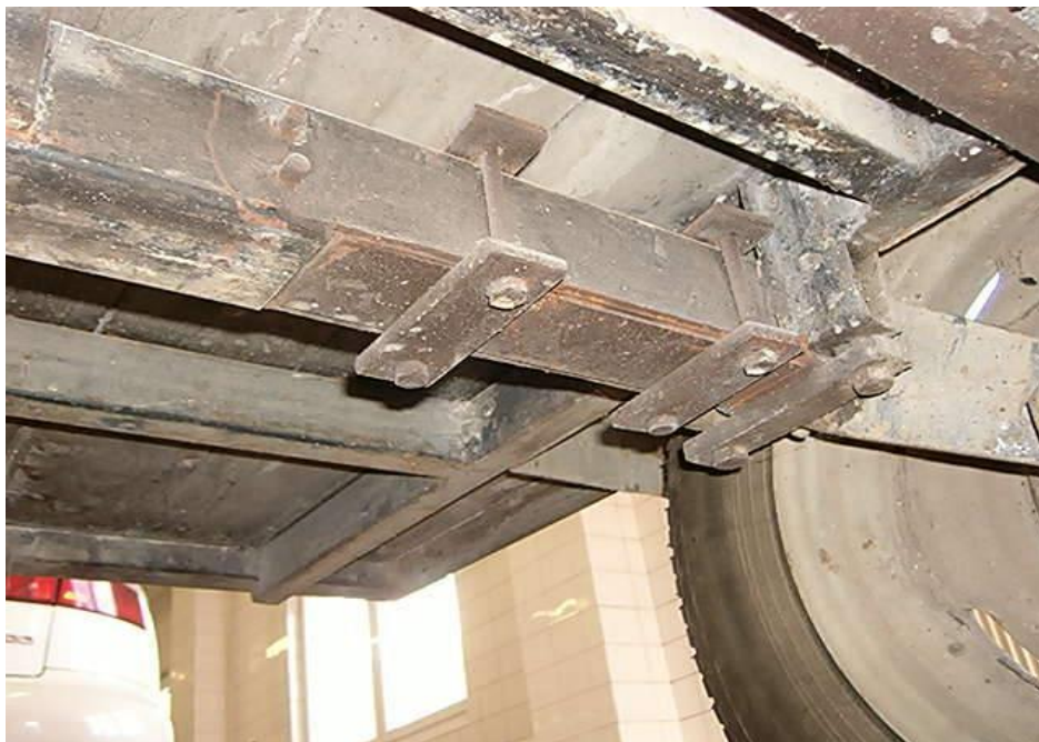
Obrázek č. 34 Prasklý rám O 1 Sportjacht, Zdroj: http://www.stkportal.cz/maestro/index.php?sekce=galerie [25.3.2016]
