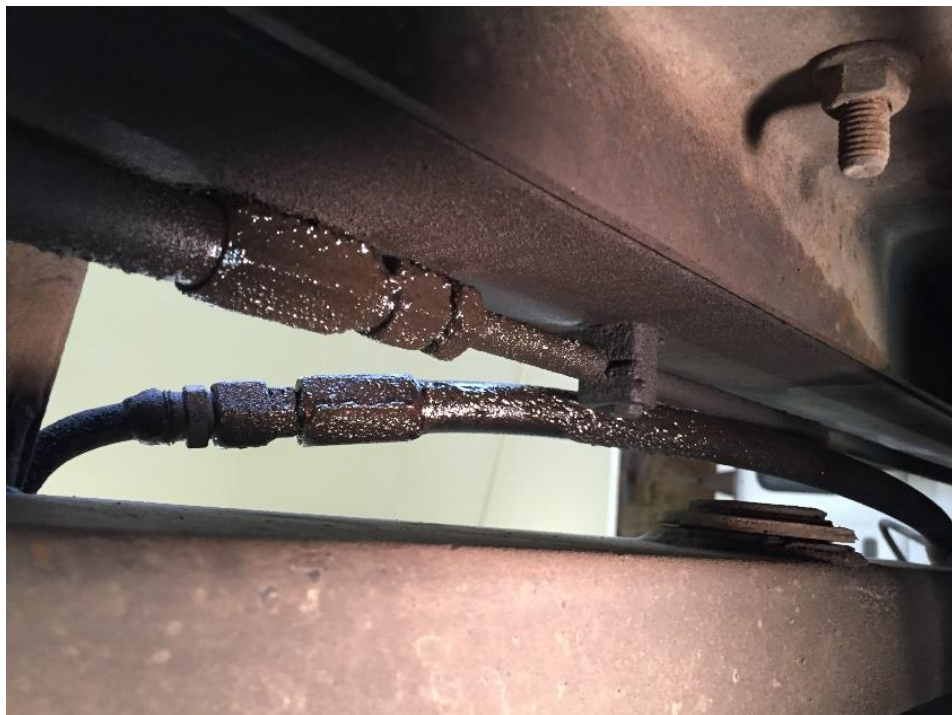
Obrázek č. 38 Únik oleje ze spoje hydraulických hadic AVIA (vlastní foto)
