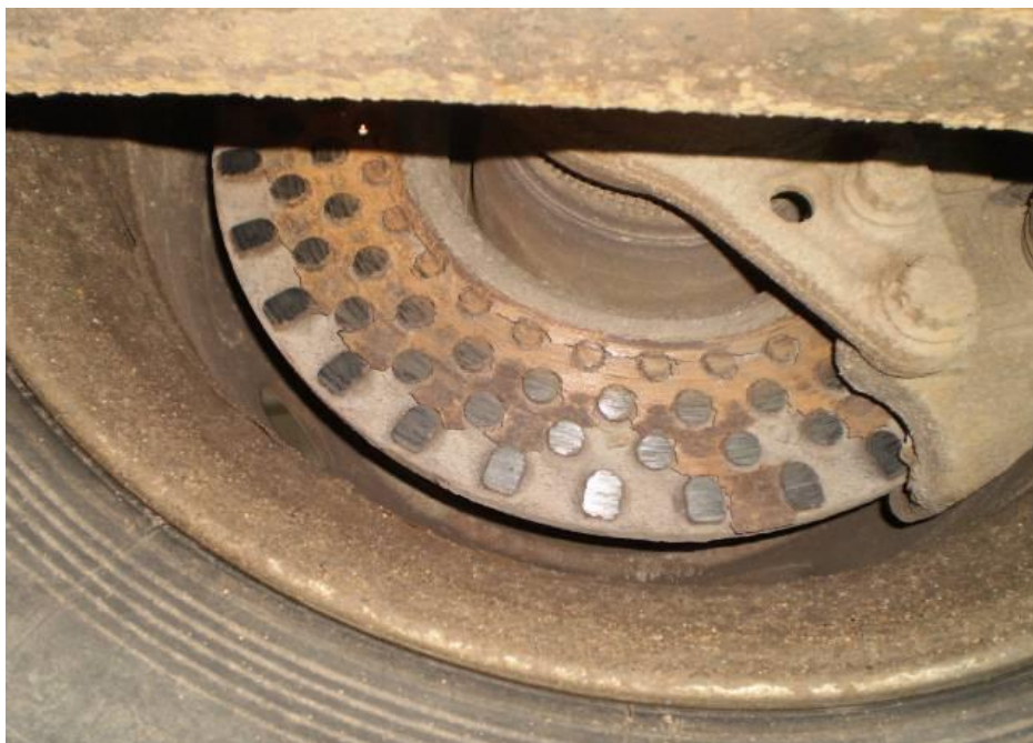
Obrázek č. 13 Korozí brzdového kotouče, Zdroj: http://www.stkportal.cz/maestro/index.php?sekce=galerie [25.3.2016]
