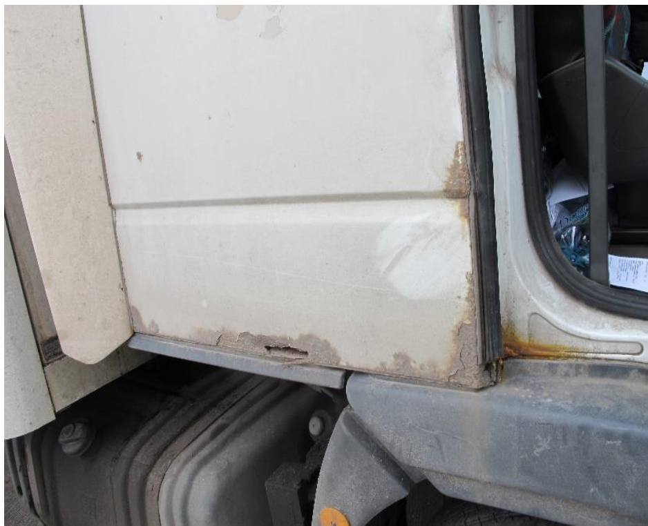
Obrázek č. 35 Koroze lemu u dveří IVECO (vlastní foto)
