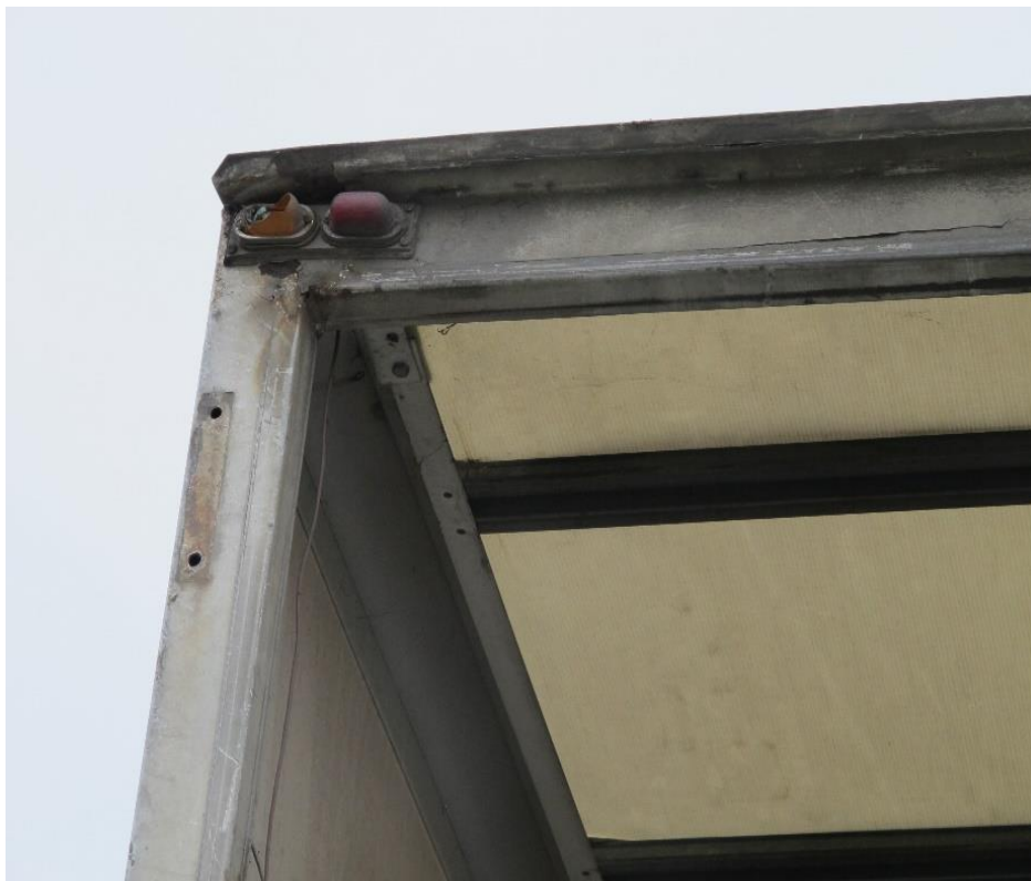
Obrázek č. 24 Poškozené zadní obrysově osvětlení IVECO (vlastní foto)
