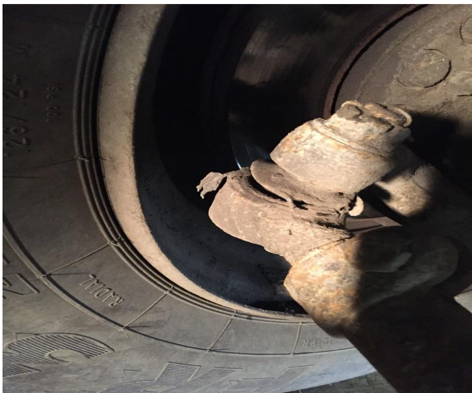
Obrázek č. 30 Poškození prachovky kulového čepu AVIA (vlastní foto)
