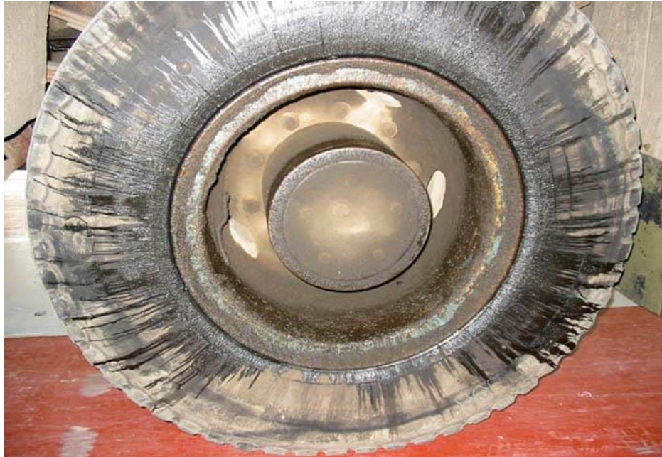
Obrázek č. 37 Únik maziva z náboje kola NA, Zdroj: http://www.stkportal.cz/maestro/index.php?sekcce=galerie [25.3.2016]
