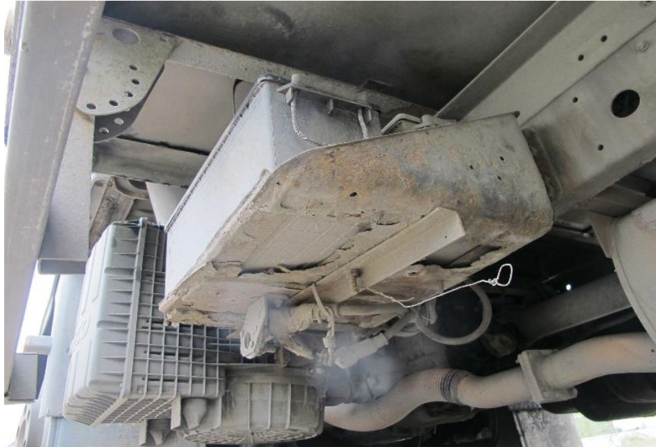
Obrázek č. 36 Koroze držáku akumulátoru IVECO (vlastní foto)
