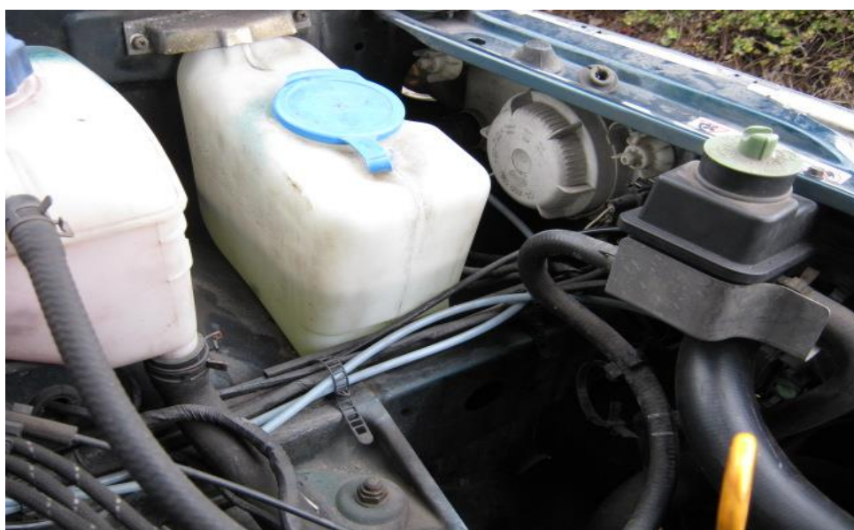
Obrázek č. 21 Vedení kapaliny od korektoru na změnu naklápění k světlometu ŠKODA Felicia (vlastní foto)
