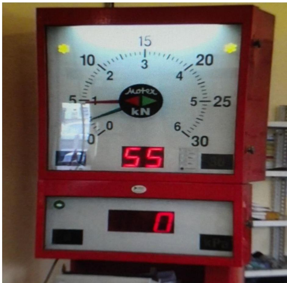
Obrázek č. 16 Nesouměrnost brzděných kol na jedné nápravě AVIA (vlastní foto)
