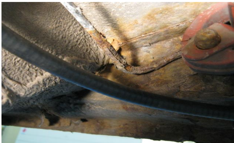
Obrázek č. 11 Koroze brzdových trubiček (vlastní foto)
