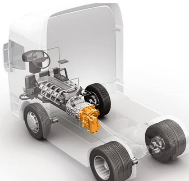
Obrázek č.9 ZF Intarder kompaktně spojený s převodovkou – zdroj: http://www.zf.com/corporate/en_de/magazine/magazin_artikel_viewpage_22067436.html 6.3.2016 Produktový list společnosti Zahnradfabrik GmbH
