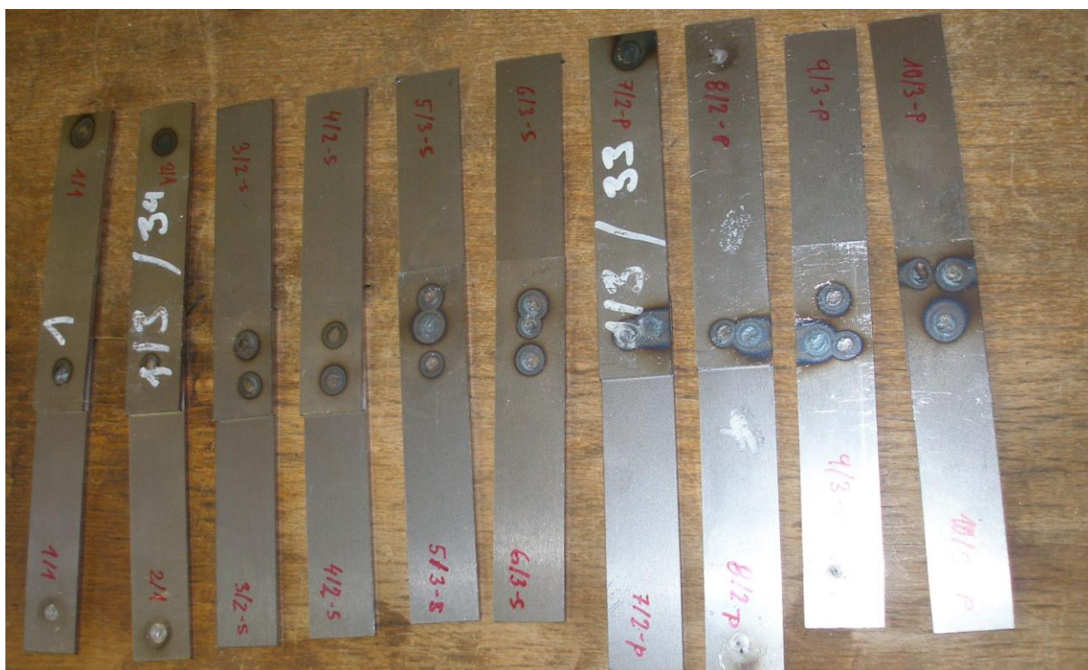
Obr. 13 Zkušební vzorky pro zkoušku tahem na smyk
