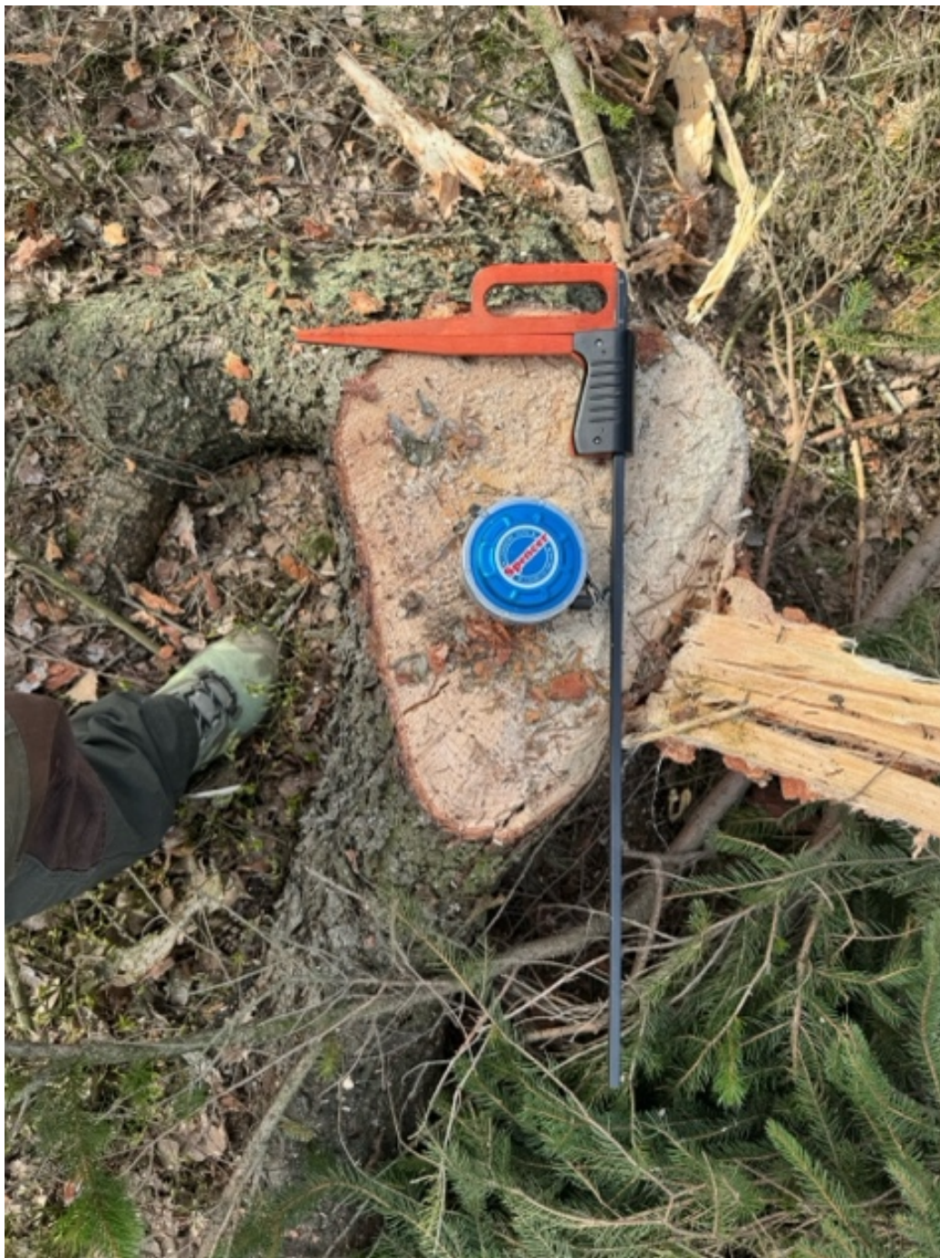
Příloha 2: Lesnická průměrka a lesnické pásmo použité při měření.
