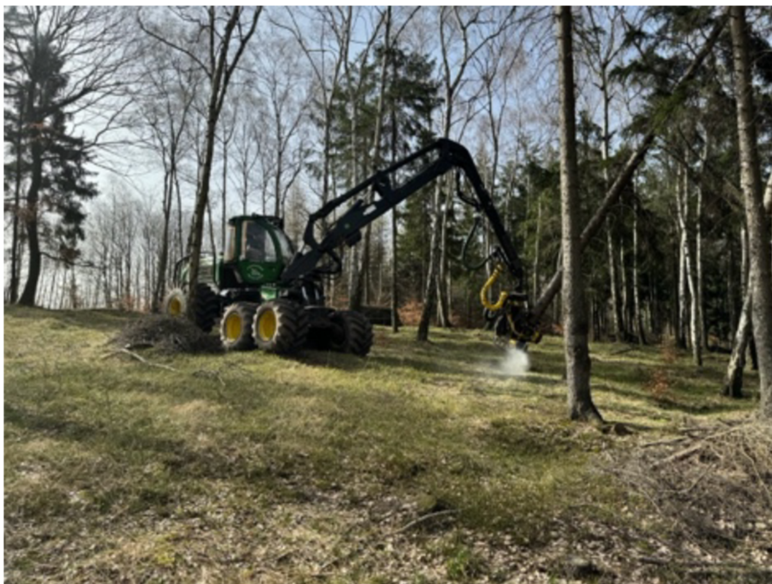
Příloha 7: Harvestor při kácení stromu.
