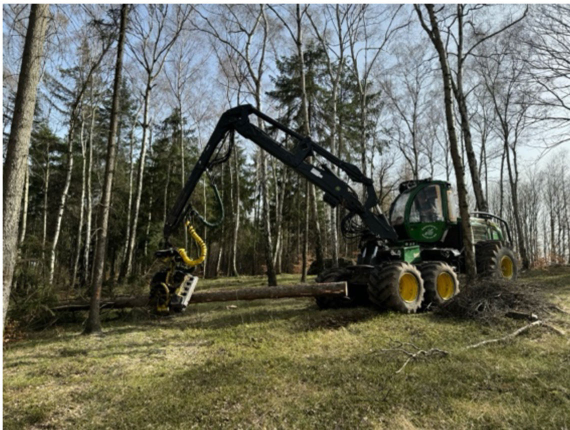
Příloha 8: Fotografie harvestoru využívaného při druhování dříví.
