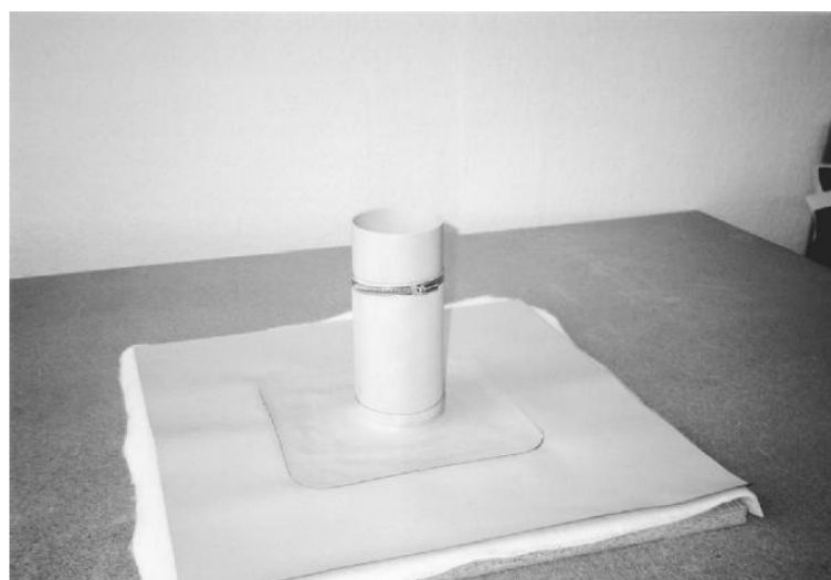
Dotěsnění fólie a stažení ocelovou objímkou
