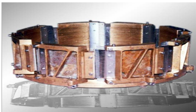
Obr. 15 Hlavice na plátkování brambor (Deoband engineering corporation)
