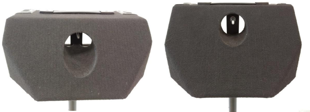
Obrázek 4-6 Nástavby po dokončení, vlevo nižší nástavba, vpravo vyšší nástavba – pohled zepředu
