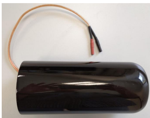
Obrázek 4-9 modul pro výškový reproduktor - boční pohled
