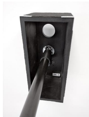
Obrázek 3-7 Kvádřová ozvučnice s asymetrickým uložením reproduktoru
