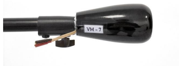
Obrázek 3-9 Ozvučnice ve tvaru kapky pro výškový reproduktor
