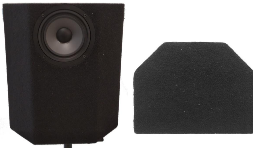
Obrázek 4-2 Ozvučnice pro středobasové reproduktor bez nástavby, přední pohled a horní pohled
