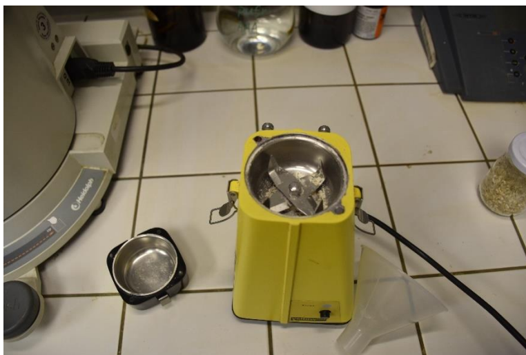
Obr. 5 - Elektrický mlýnek určený k přípravě vzorků na analýzu, vlastní zdroj
