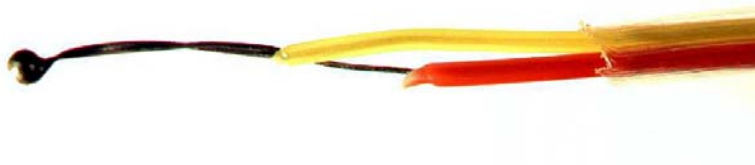
Obr. 3.5 Detail zakončenia termočlánku – merací spoj
