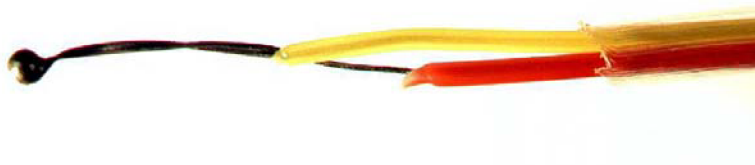
Obr. 3.5 Detail zakončenia termočlánku – merací spoj
