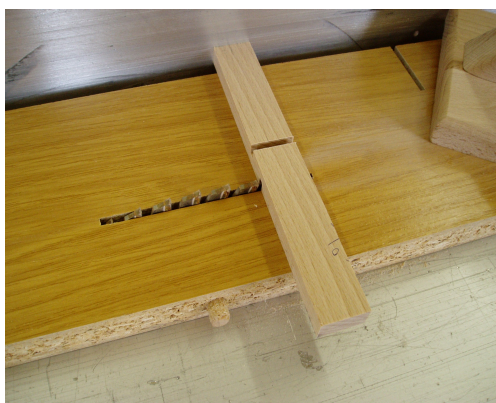
Obr.9: Výroba těles - řezání drážky
