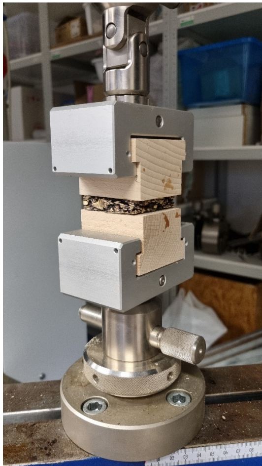
Obr. 12: Zkušební vzorek uchycený do zkoušecího stroje
