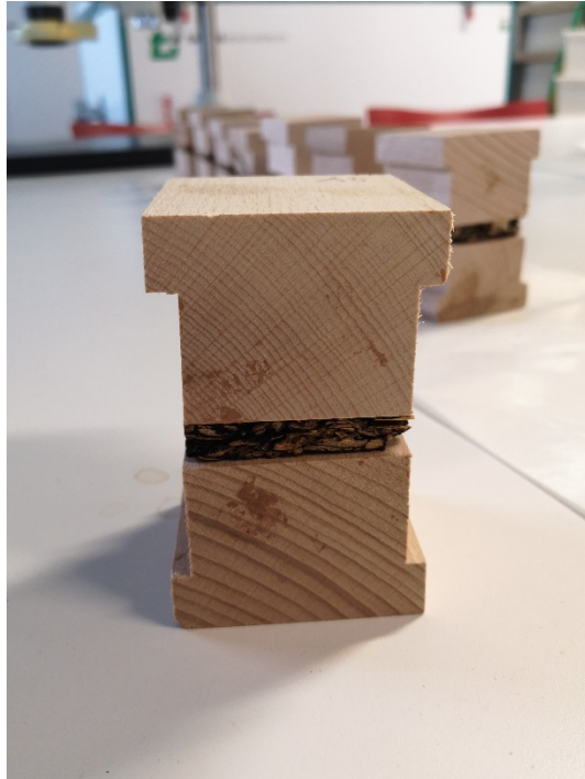
Obr. 11: Upevnění zkušební vzorku k masivnímu dřevu
