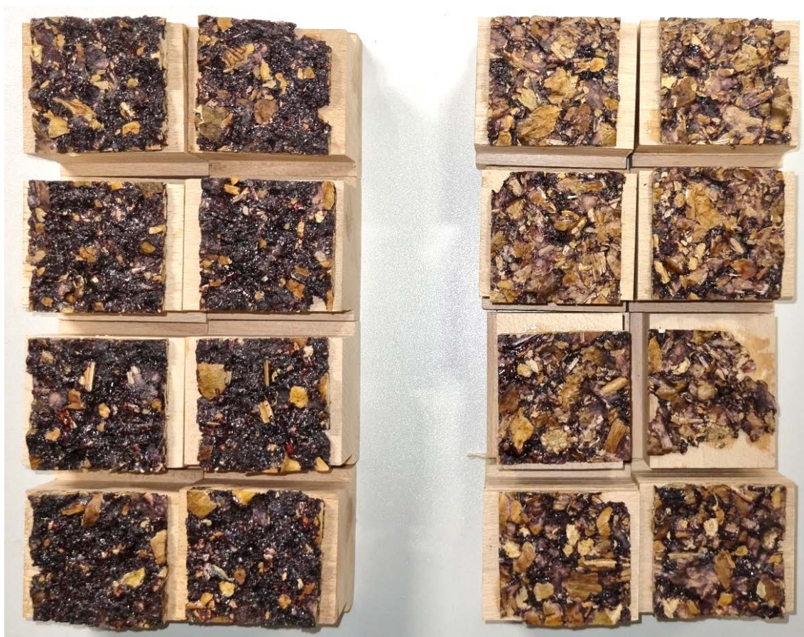
Obr. 22: Zkušební vzorky po testování odlupčivosti
