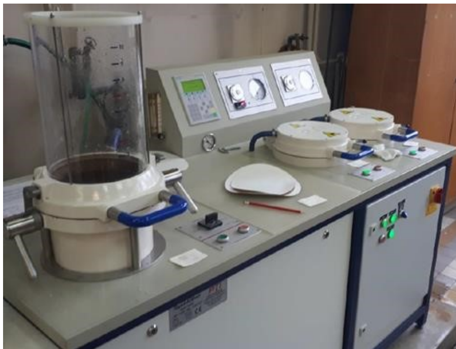
Obr. 14: Laboratorní archovač RAPID-KÖTHEN RK-2A (Škrabálek, 2023)
