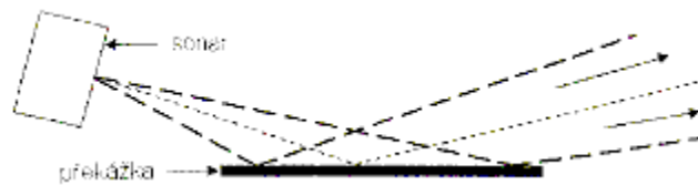
Obrázek 3.5: Chyba sonaru - příliš ostrý uhel
