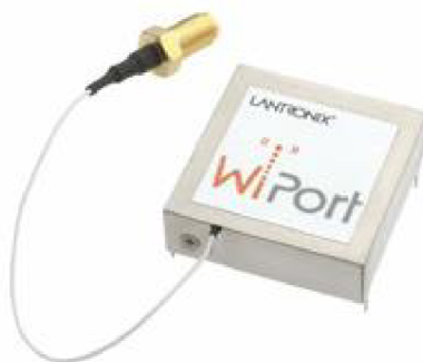
Obrázek 3.15: bezdrátový WiFi modul WiPort™ od výrobce Lantronix®
