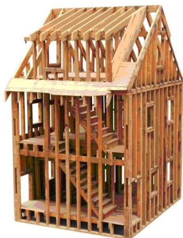
Obr. č. 6 – Balloon frame (zdroj: https://deeperenergyretrofit.files.wordpress.com/2010/06/balloon-frame.jpg )
