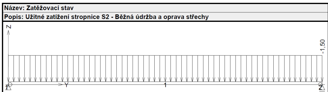
Obr. č. 61 Zatěžovací stav – užiténé zatížení stropnice S2 (Zdroj: Autor – Martínek – FIN EC, 2020)
